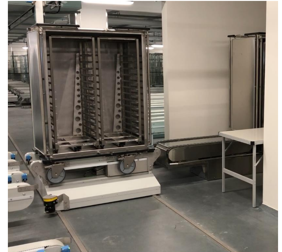
Eksempel på automatisk overføring av tomme transportvogner fra transportbaner til innlastere til vognvaskmaskiner
