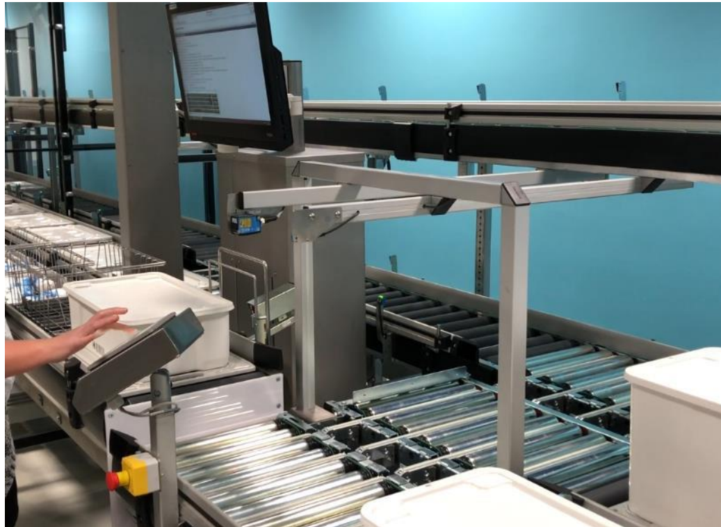
Eksempel på høydejusterbar manuell stasjon for pakking av enkeltpakkede instrumenter i kasser for innlagring
