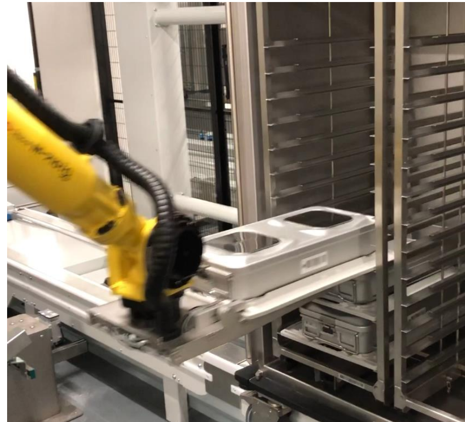
Eksempel på robot for tømming av transportvogner hvor containere og kasser tas ut av prosedyrevognene
